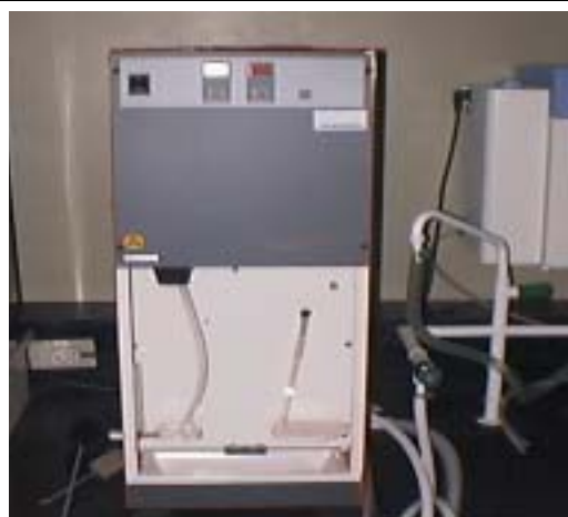
氨氮分析設備
