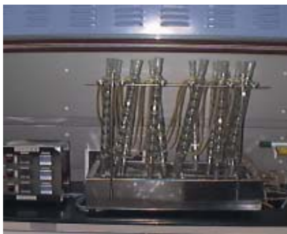
COD 迴流加熱設備
