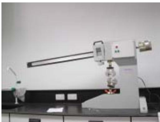
水泥砂漿抗拉試驗機
