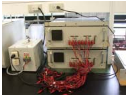
名稱：BAT-790 電池充放電分析儀 用途：電池充放電容量、電位變化分析
