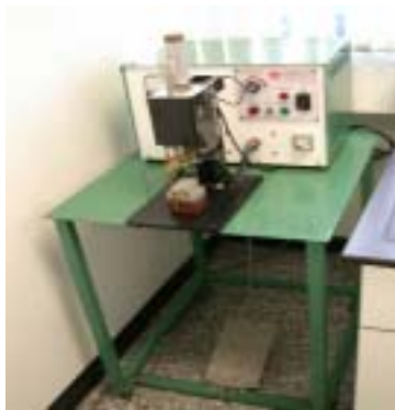
名稱：點焊機 用途：金屬焊接
